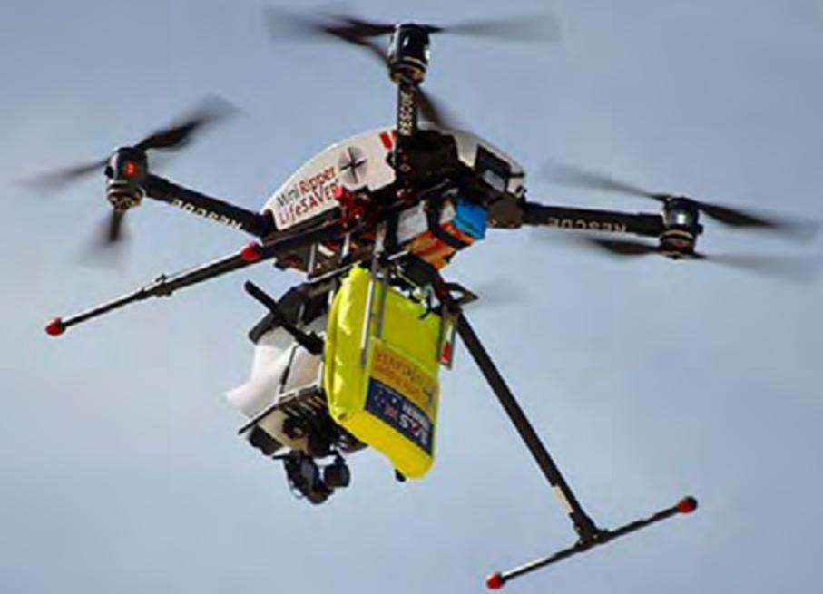
Figure 6. Un petit Ripper Life Saver UAV transporte un dispositif de flottaison gonflable.
